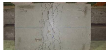
(d) Slab S4; SCC with steel fibers (0.75%)
